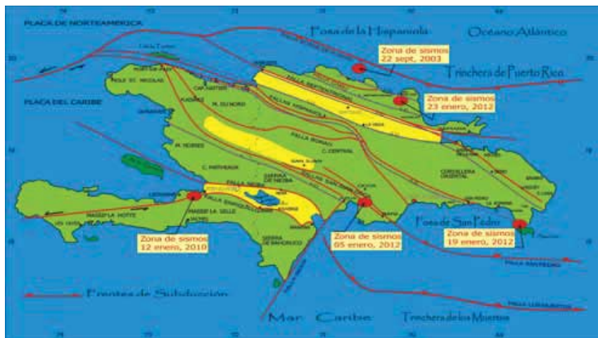
Principales lineamientos tectónicos de La Hispaniola y aceleraciones esperadas en caso de un terremoto. (R. Osiris de León, 2012).
